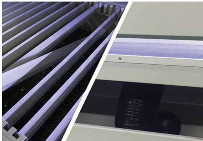
カッター式作業台と台下にあるダクト装置
